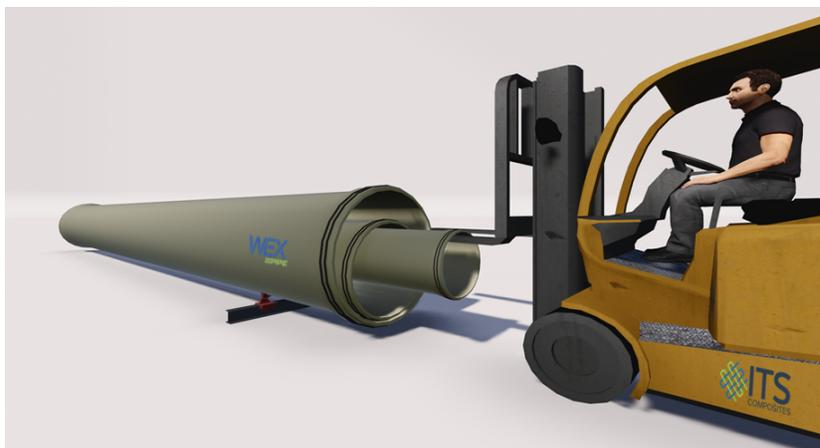
Imagen 6: Removiendo tubería telescópica.
