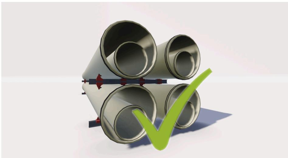
Imagen 10: Manera correcta para almacenamiento de tubería.
